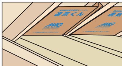
②「通気くん」をころび止めに突き付けるように施工します。
